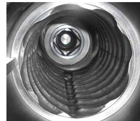
Alojamiento del accionamiento robusto y carcasa de sinfín maciza de acero inoxidable
