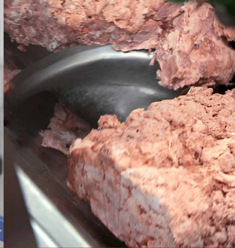
Sinfín alimentador de fundición especial con filo de pelado
